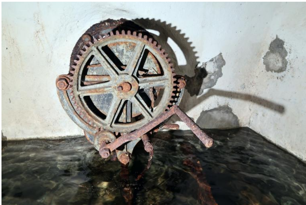
Vue du treuil manuel à tambour du monte-charge. Il a conservé sa manivelle
