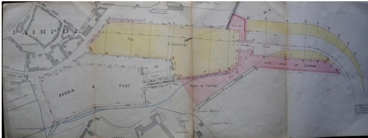
Plan du port de Paimpol en 1893 : projet d'agrandissement du bassin à flot, avec la nouvelle jetée de Kerno et le bassin d'échouage (AD 22)
