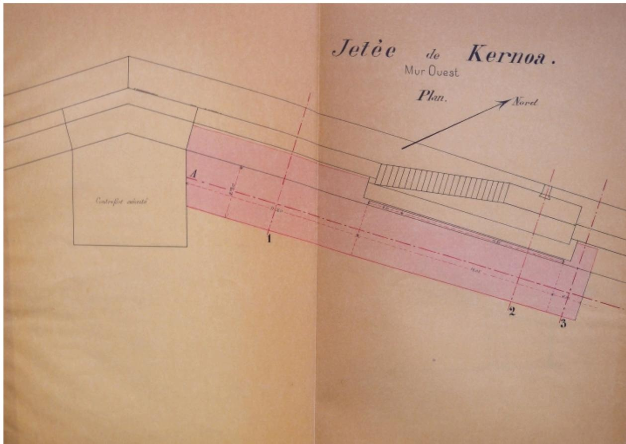
Plan : renforcement de la jetée de Kernoa, du mur Ouest avec profil en béton, 1902 (AD 22)
