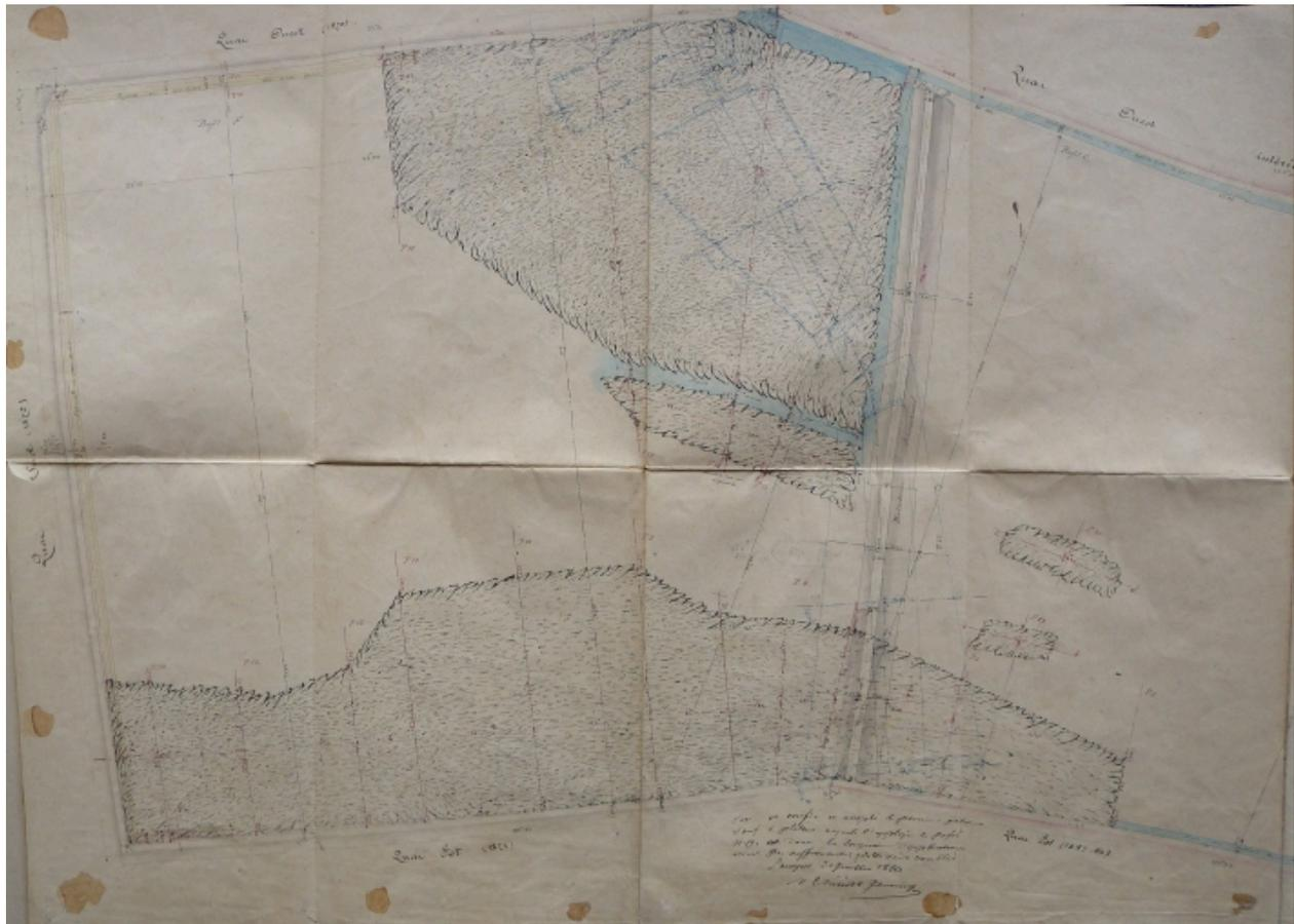
Plan général de l'ouvrage : digue provisoire du bassin à flot, 1886 (AD 22)
