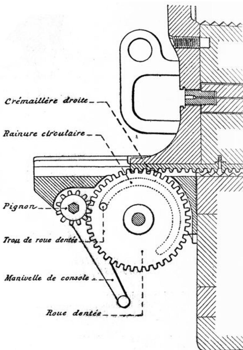
Fig. 61. — Mécanisme de translation de la culasse de 32<sup>e</sup> m, M<sup>le</sup> 1870-1881.
