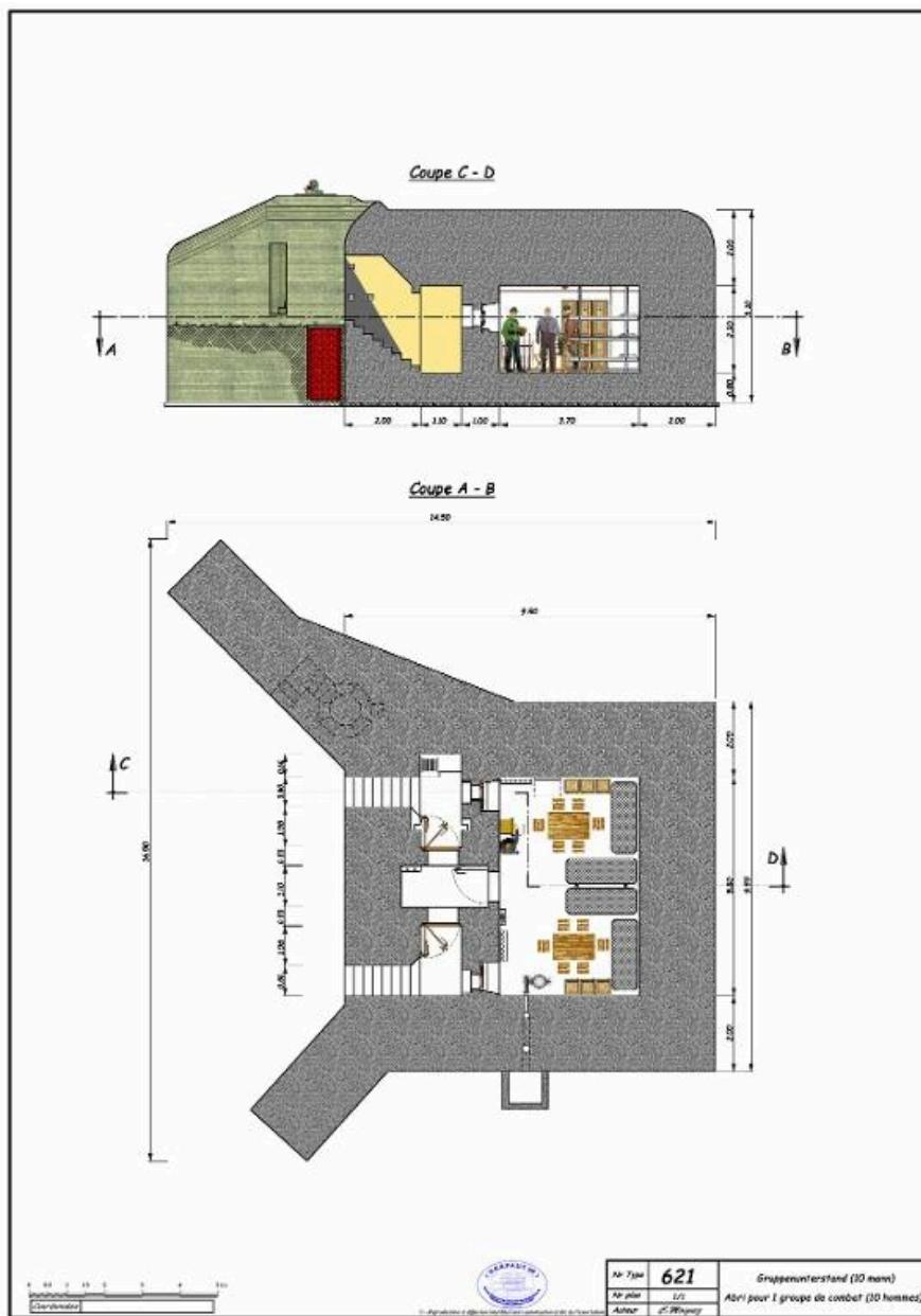
Plan et coupe d'un bunker-abri de type 621 pour un groupe de combat
