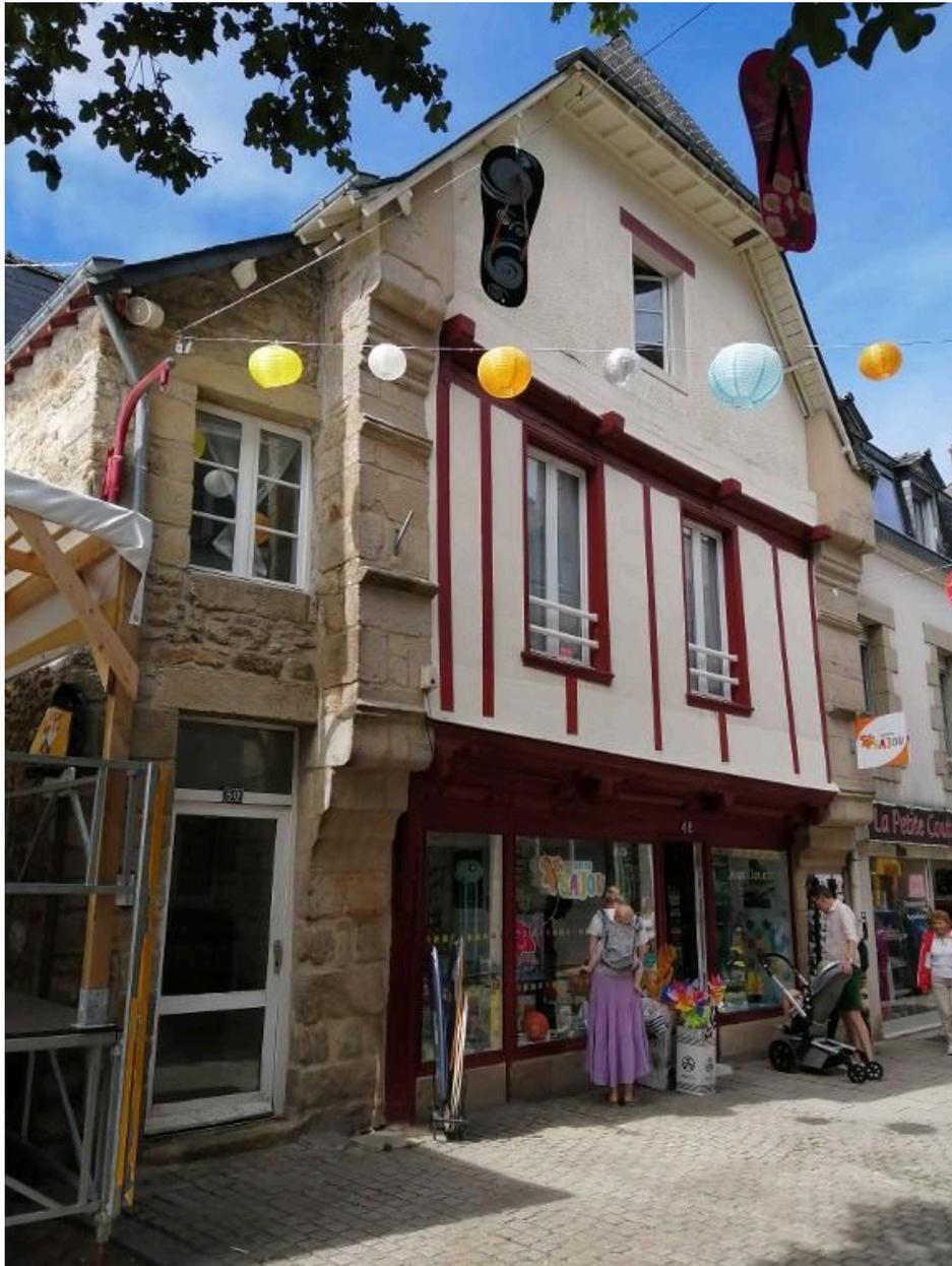
Façade à pan de bois avec encorbellement sur solives et détail de l'extension en maçonnerie
