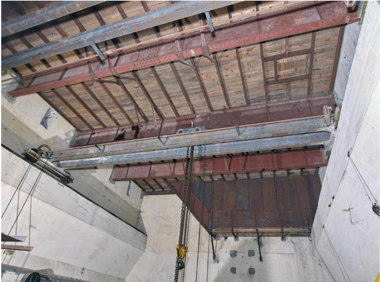
Vue générale du pafond de la salle avec ses deux ponts roulants bipoutres et treuils.
