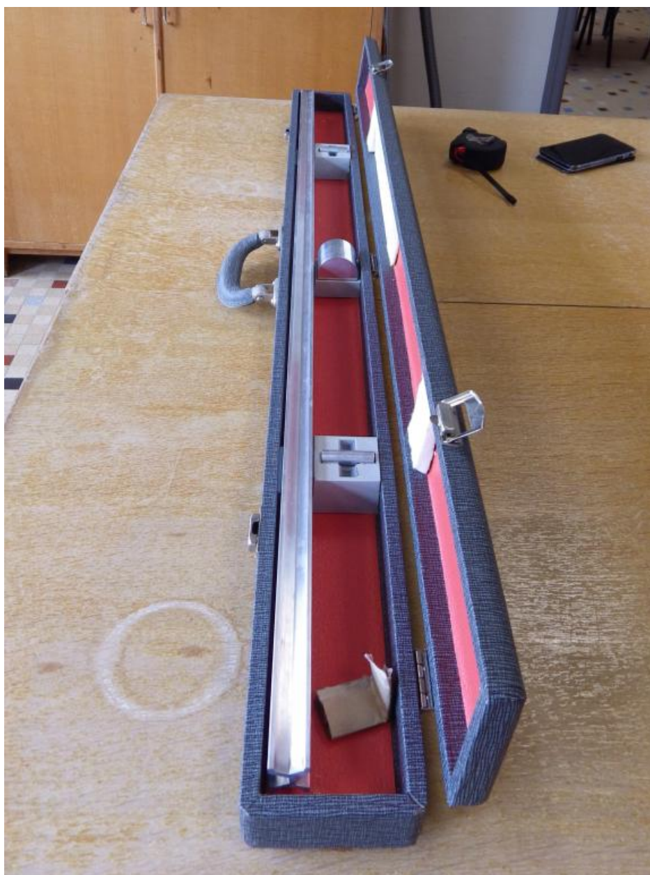
Modèle de mètre-étalon à traits - Pesanteur-Mécanique-Mesure (C.E.M.S., 1968)
