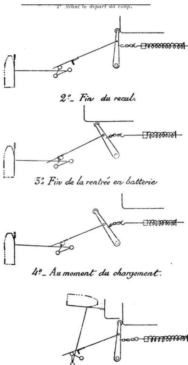
Détail de la manoeuvre d'un affût modèle 1886 PA pour canon de 27 cm
