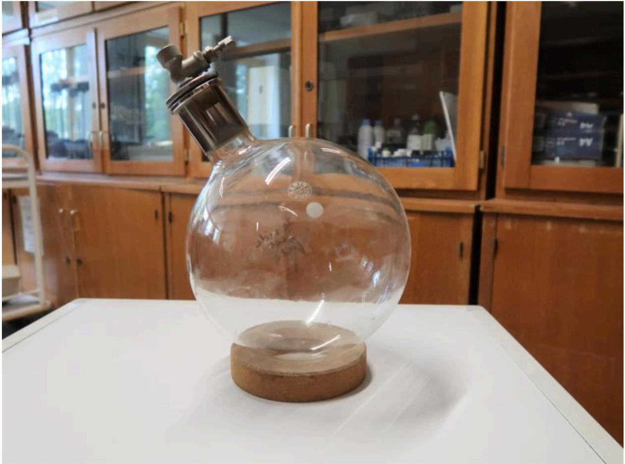
Ballon pour déterminer la masse et la masse volumique d'un gaz - Propriétés des gaz
