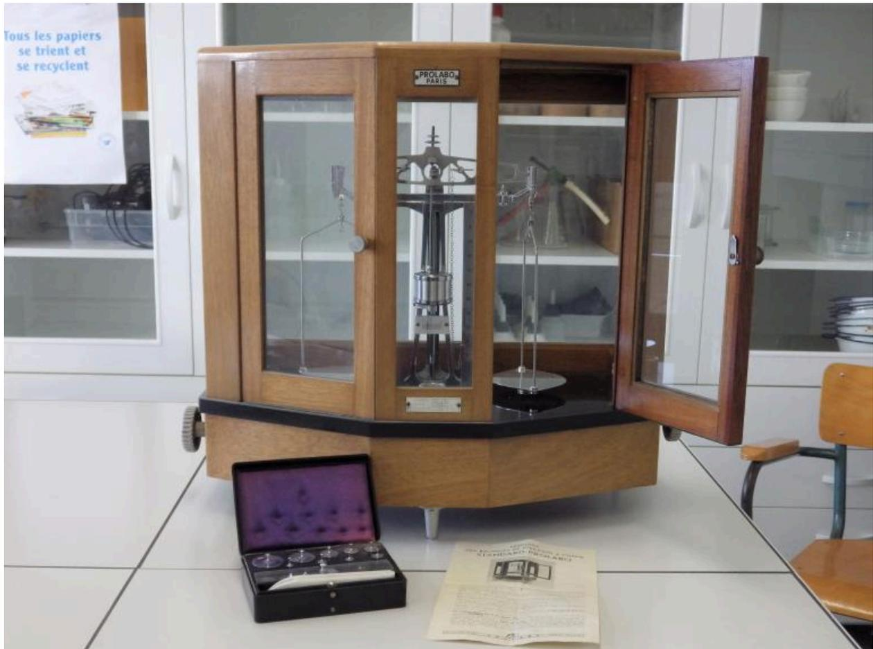
Balance de précision et sa boîte de masses marquées - Pesanteur-Mécanique-Mesure (Matlabo)
