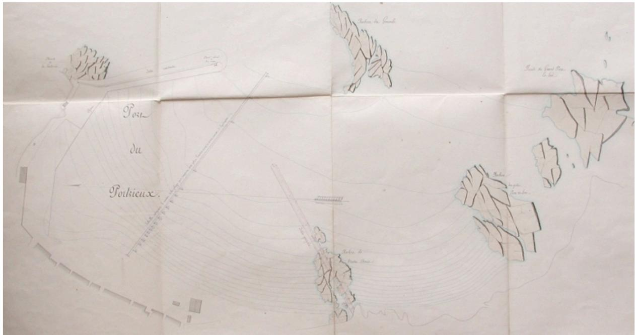
Plan : jetée existante à l'ouest à la pointe de la Batterie et jetée projetée à l'est sur le rocher du Terre Denis, 1854 (AD 22)
