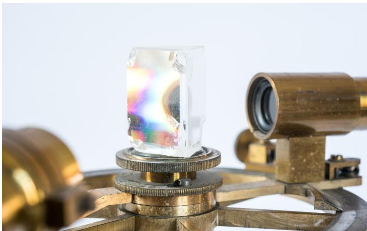
Détail de la plate-forme du goniomètre de Babinet sur laquelle est placé un prisme
