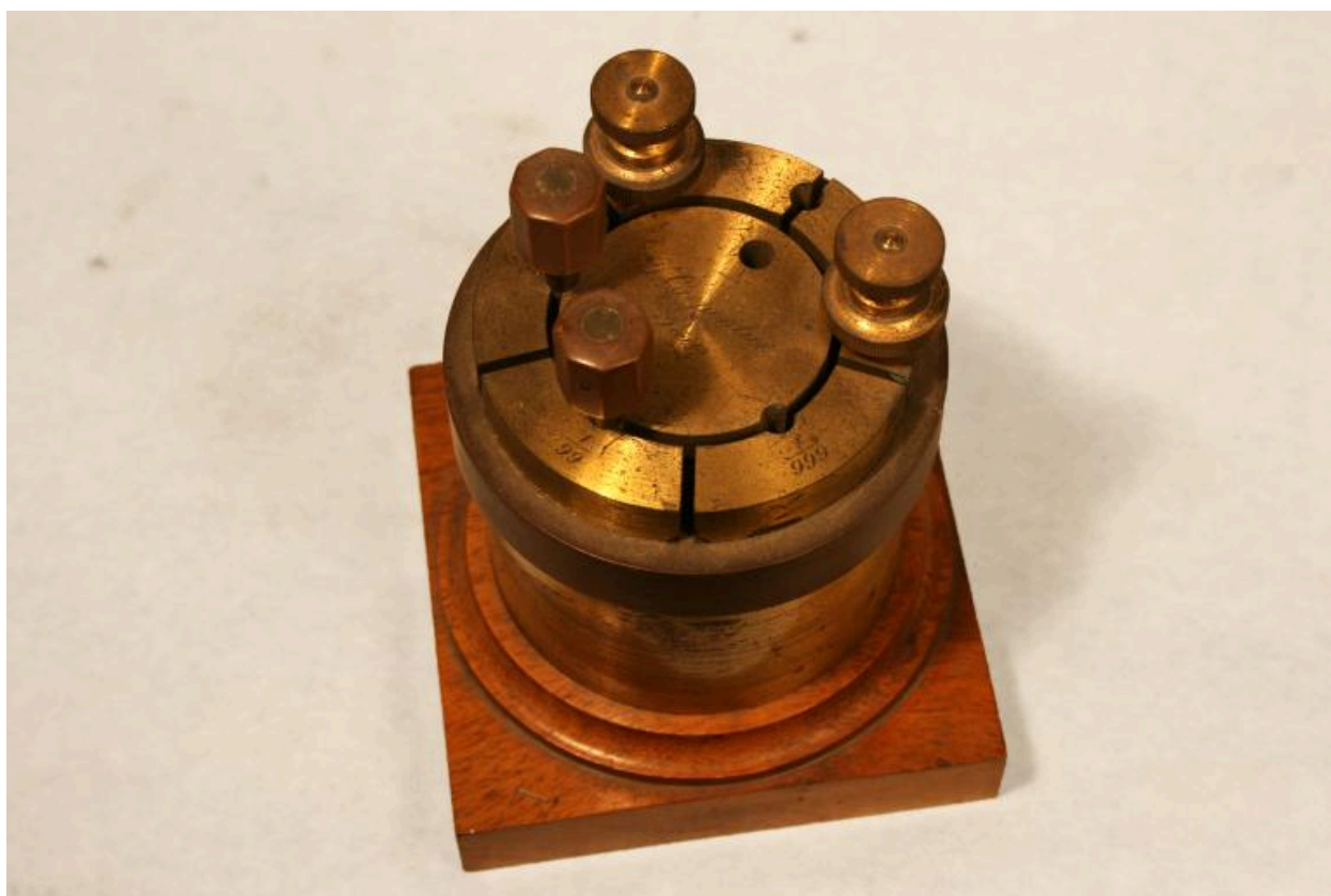
Shunt galvanomètre (ou réducteur simple de galvanomètre) - Electricité dynamique (J. Carpentier)
