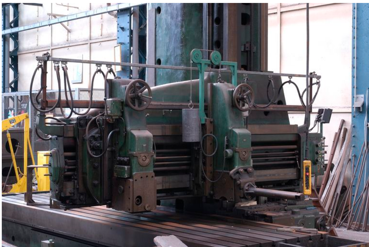
Vue de la halle d'usinage : détail de l'aléseuse Berthiez (1949)
