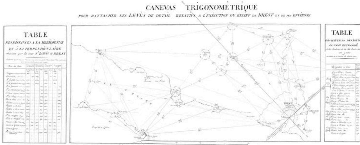
Plan-relief de Brest, 1807. Canevas trigonométrique pour rattacher les levés de détail relatifs à l'exécution du relief de Brest et de ses environs
