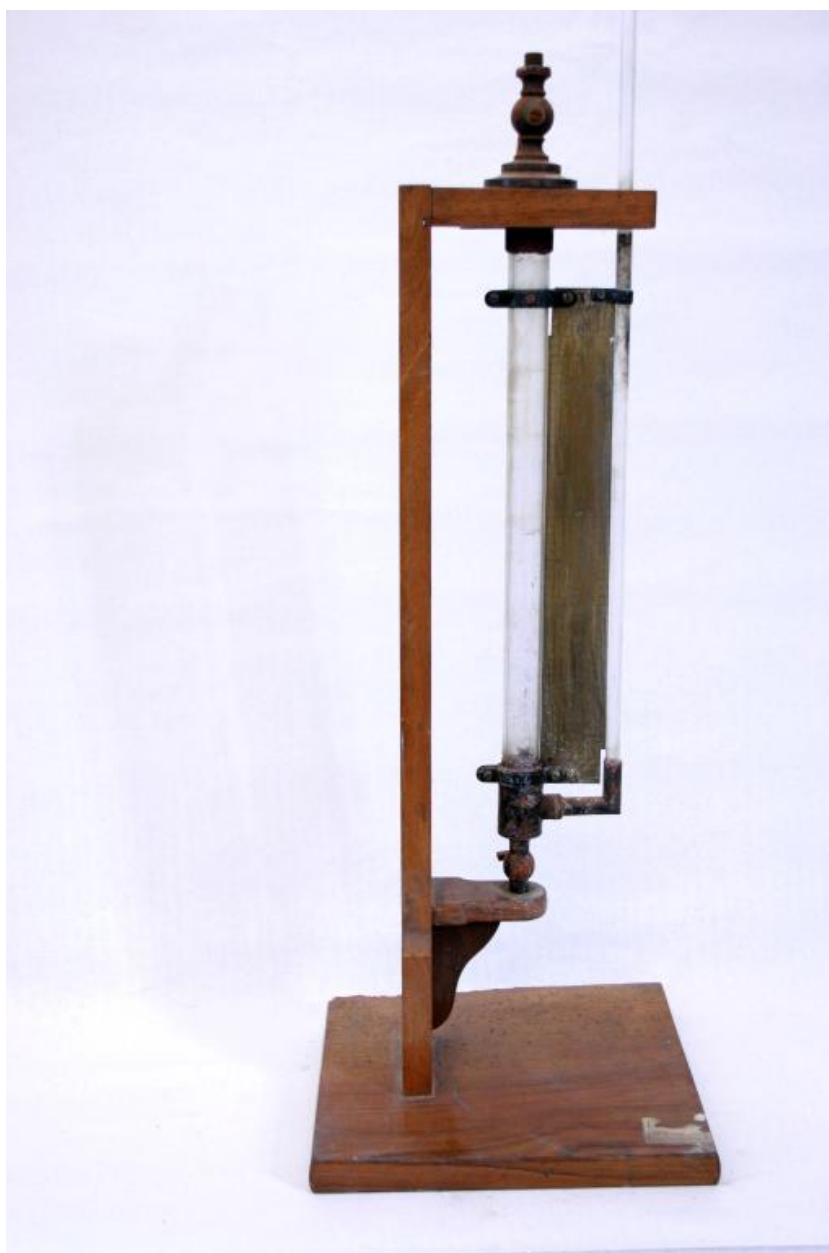
Appareil de Gay-Lussac (mélange des gaz et des vapeurs - Chaleur (Non signé))
