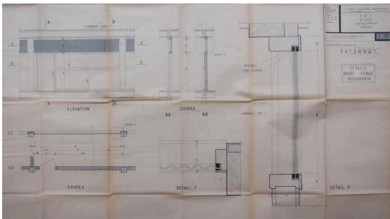
Externat : détail bande vitrée dégagement (Hervé Péron et Alexandre Weisbein, architectes, 1964). Afin d'apporter un peu plus de lumière dans les dégagements centraux, des bandes vitrées, en "Verondulit", sont posées en imposte des cloisons entre les salles de classes et le couloir.
