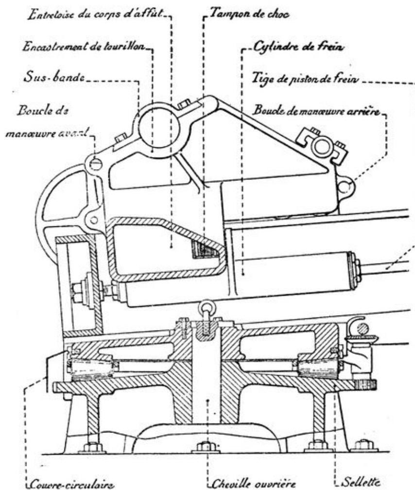
Fig. 80. — Avant de l'affût de 27<sup>c/m</sup>, M<sup>le</sup> 1886 P.A.
