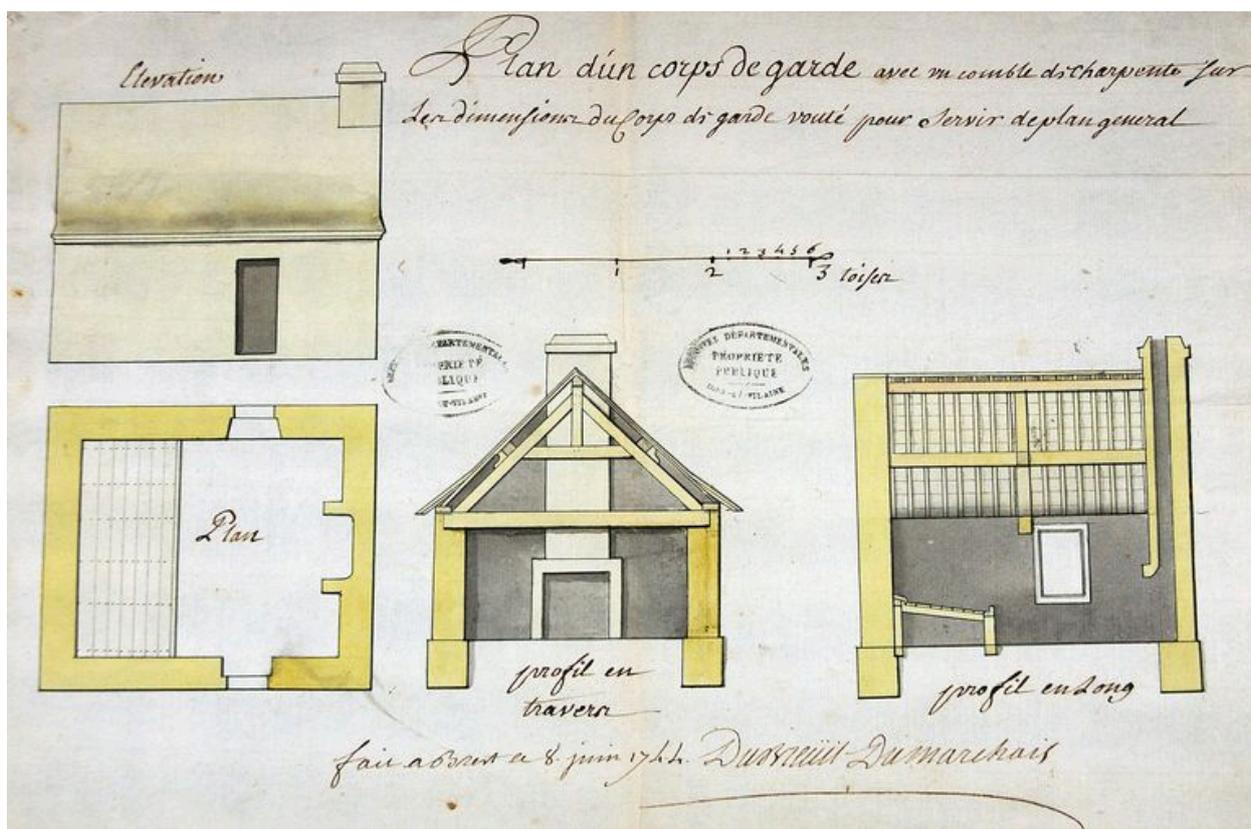
Elévation, plan et profil d'un corps de garde avec comble de charpente sur les dimensions du corps de garde voûté pour servir de plan général, fait à Brest le 8 juin 1744 par Dubreuil Dumarchais
