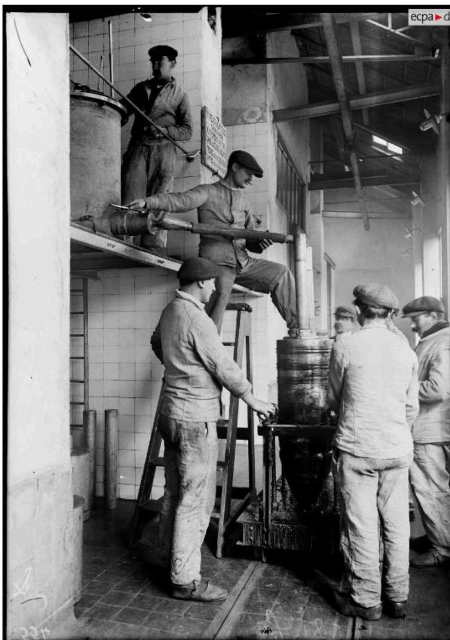
Vue intérieure d'un atelier en 1916 : coulée de mélinite dans un obus de 340 mm depuis une cuve surélevée. L'équipe est masculine. Cet atelier carrelé à charpente métallique est traversé par une voie ferrée étroite sur laquelle circulent les chariots
