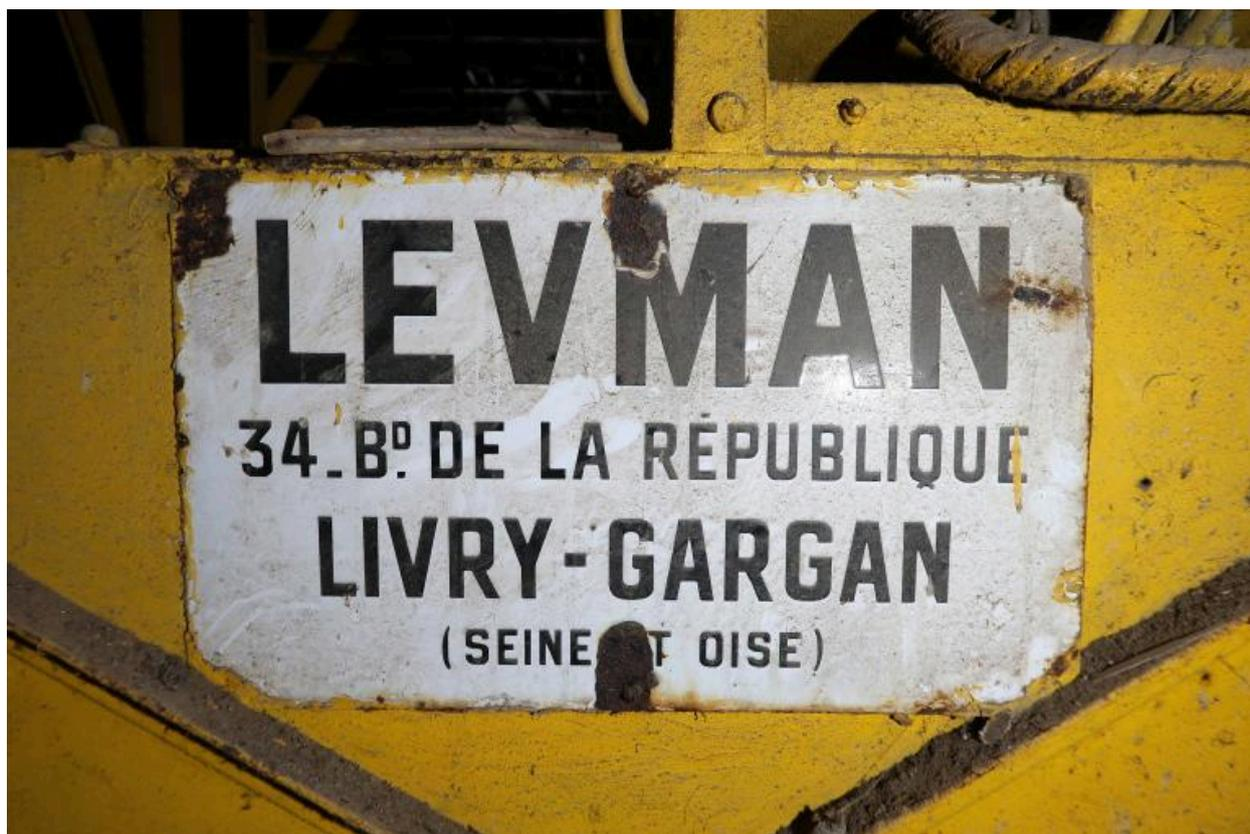
Vue de la plaque constructeur du pont roulant : LEVMAN 38 Bd DE LA REPUBLIQUE LIVRY-GARGAN (SEINE ET OISE). Sa capacité maximum est de 2 t
