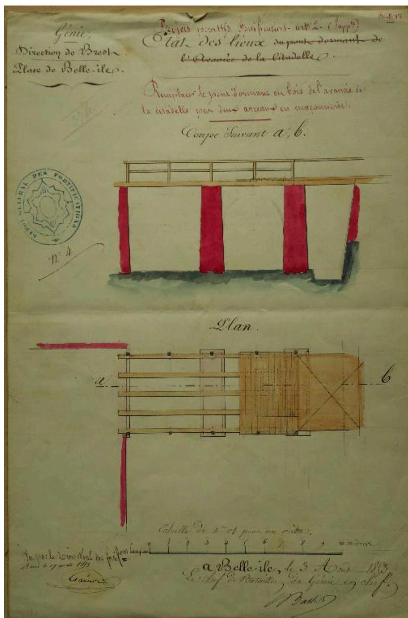
1 VH 293. Place de Belle-Ile, feuille n° 8 des projets pour 1853, remplacer le pont-dormant en bois de l'avancée de la citadelle par deux arceaux en maçonnerie, état des lieux, 3 août 1853.
