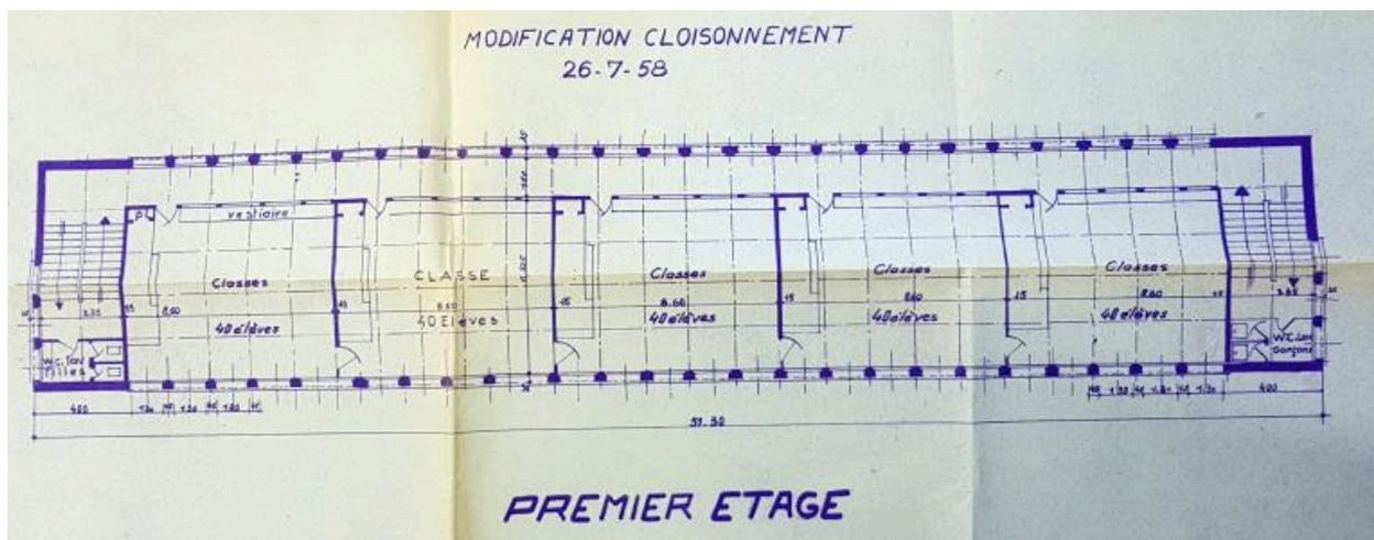
Modification cloisonnement du 1er étage, sans nom, 26/07/1958 (AM Lorient, 1NC1385). Il s'agit sans doute d'un module de 50 m du bâtiment B, ou du bâtiment C. Deux escaliers le desservent. On note la trame de 1,75 m. 5 trames équivalent à une classe de 40 élèves. L'emplacement de l'estrade y est figuré.
