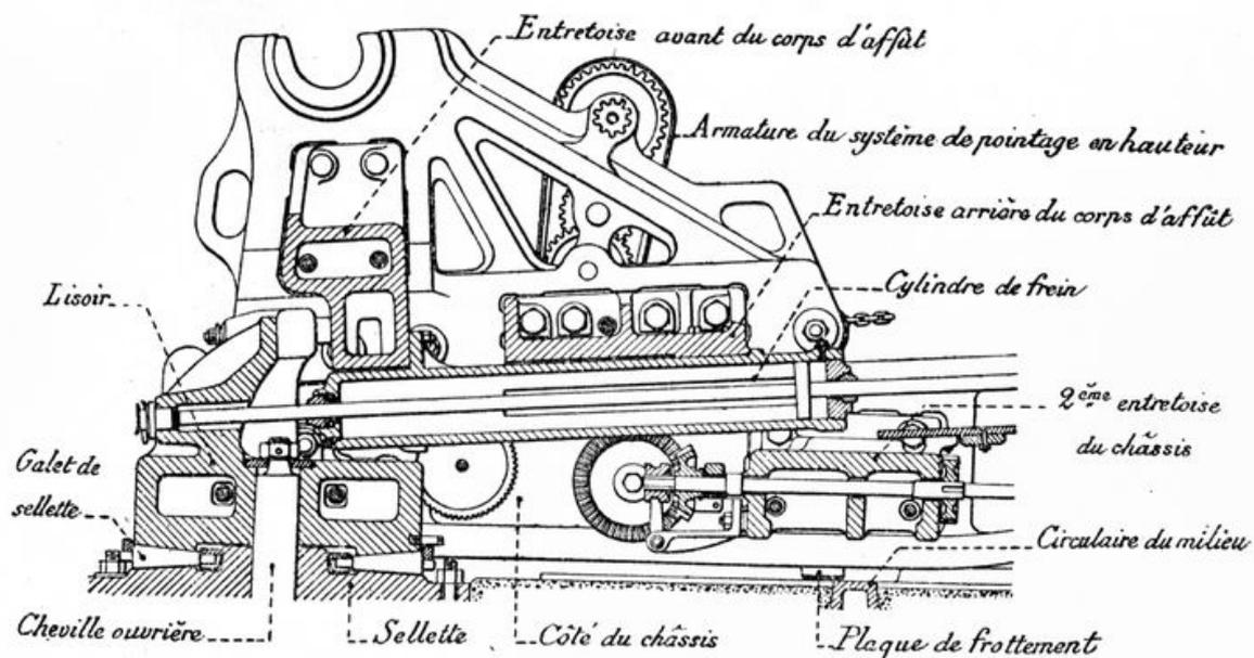
Plan détaillé de l'avant d'un affût modèle 1882 PA (modèle courant pour les batteries de la rade de Brest) pour canon de 32 cm
