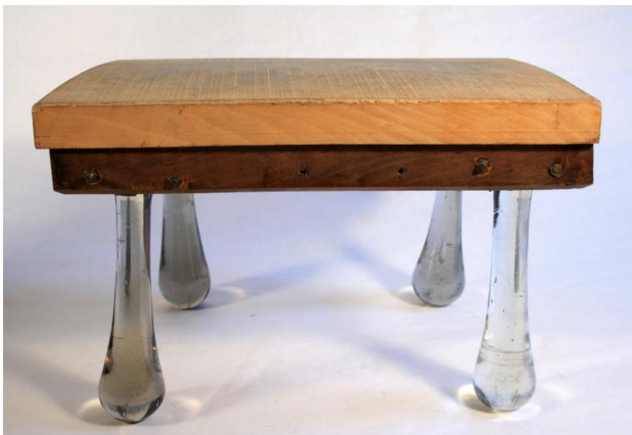
Tabouret isolant de Mascart – Electricité statique (Non signé)
