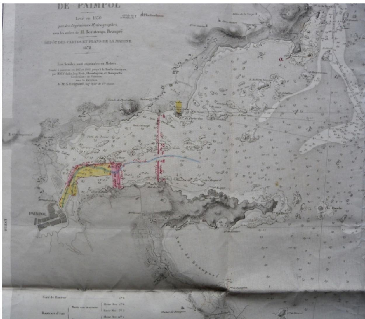
Carte hydrographique, 1893 : projet d'écluse à la pointe de Roc'h ar Fave et de jetée à la pointe de Birvidic, coupant le chenal d'entrée au port (AD 22)
