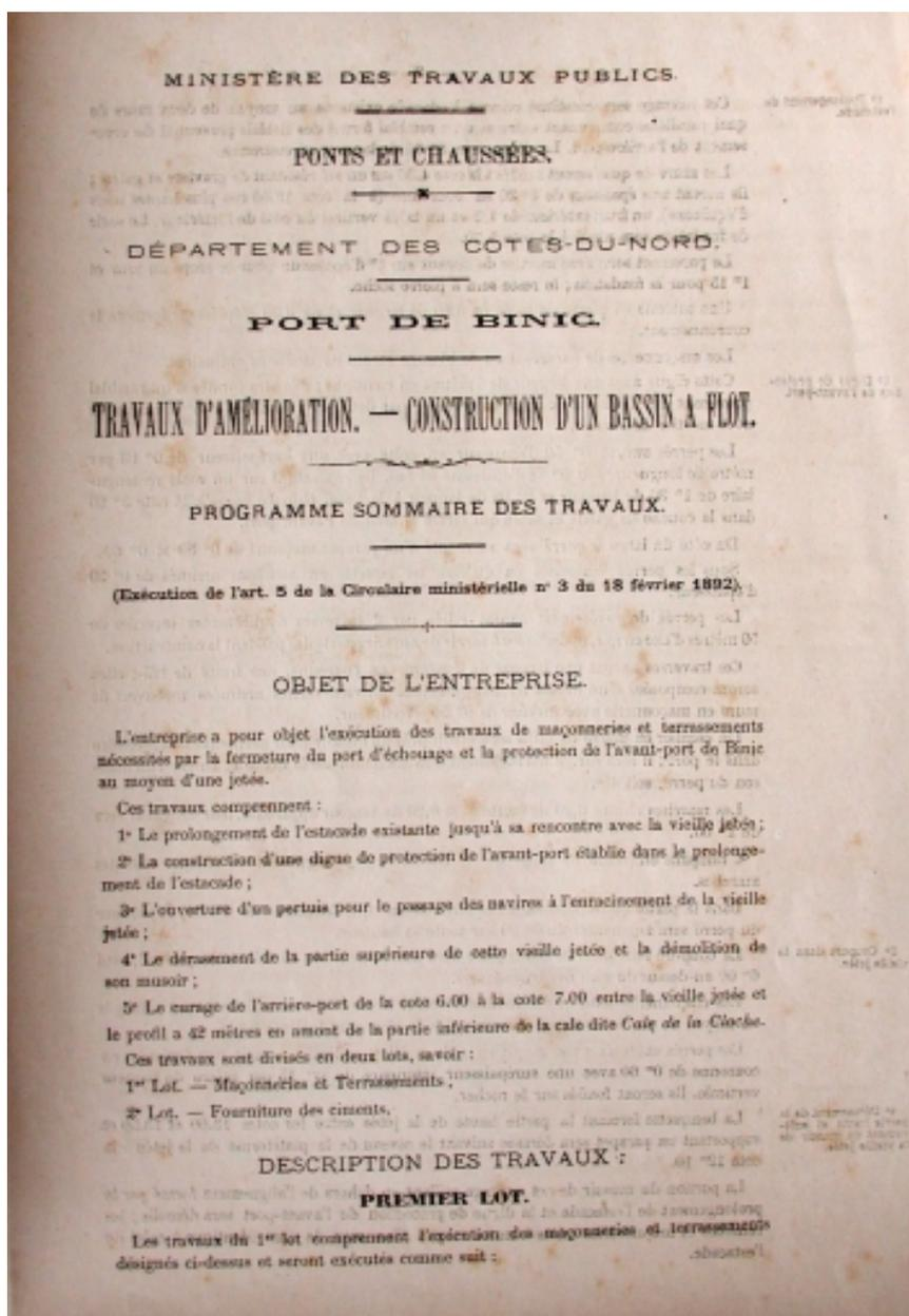
Programme des travaux : construction d'un bassin à flot et descriptif de l'adjudication en 1892 (AD 22)
