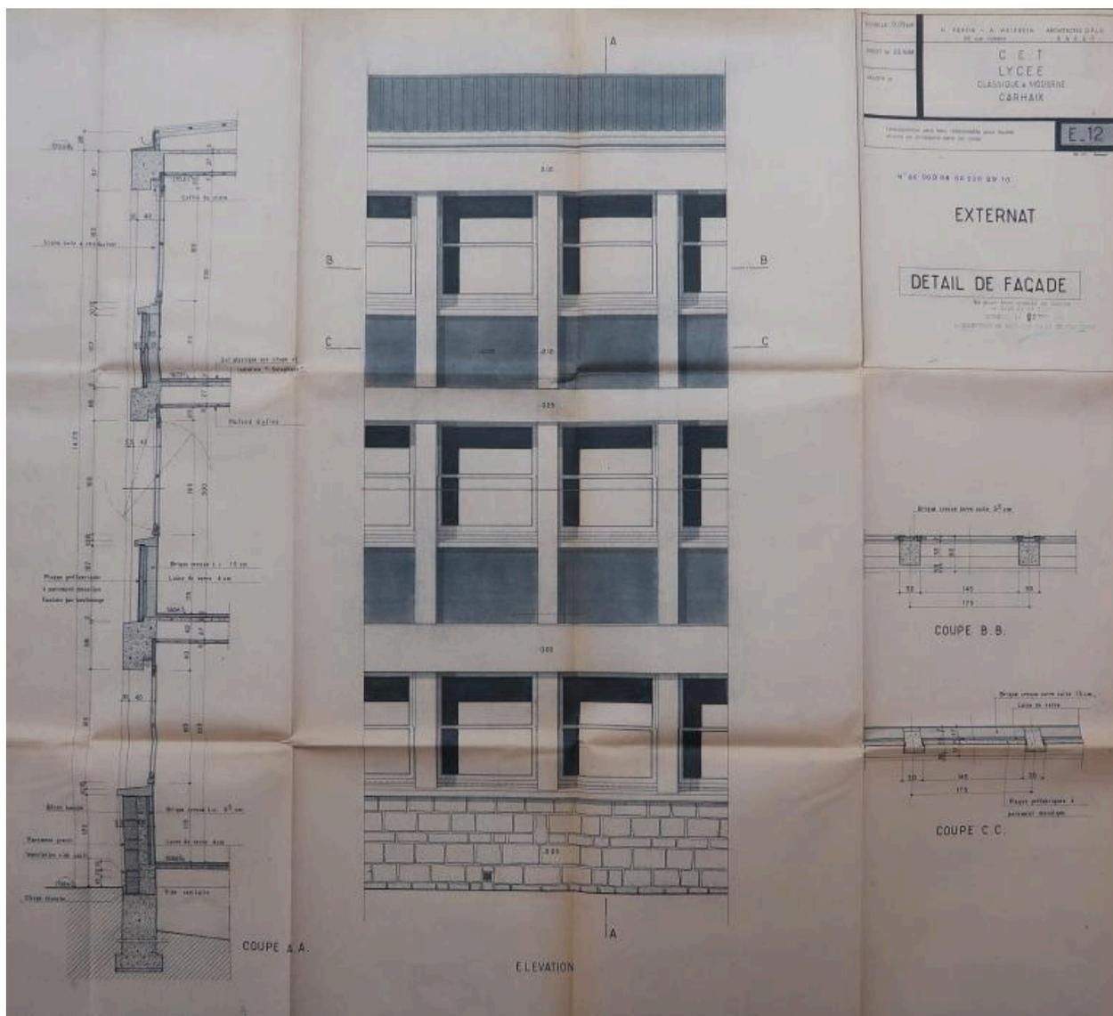
Externat : détail de façade (Hervé Péron et Alexandre Weisbein, architectes, 1964) : pierre en parement au rez-de-chaussée, alternance régulière de la trame, principe de "remplissage" entre deux poteaux (noter la présence d'une fine couche (4 cm) de laine de verre, au niveau des allèges).
