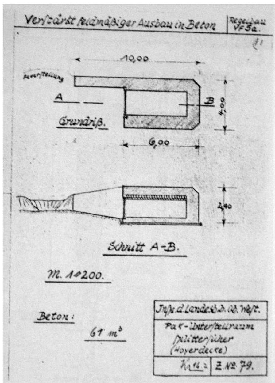
Plan d'un bunker-abri-garage de type VF 5a (Verstärkt feldmässiger Ausbau in Beton, Regelbau VF5a : Pak-Unterstellraum, Splittersicher [pare-éclats], Hoyerdecke [poutres Hoyer])
