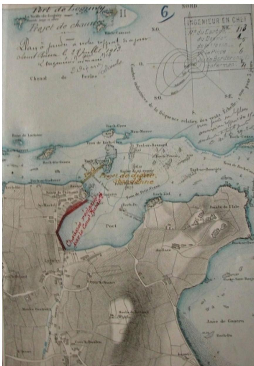
Plan général du port de Loguivy en 1913 : chaussée et rampe d'accès projetées, projet de digue abandonné (AD 22)
