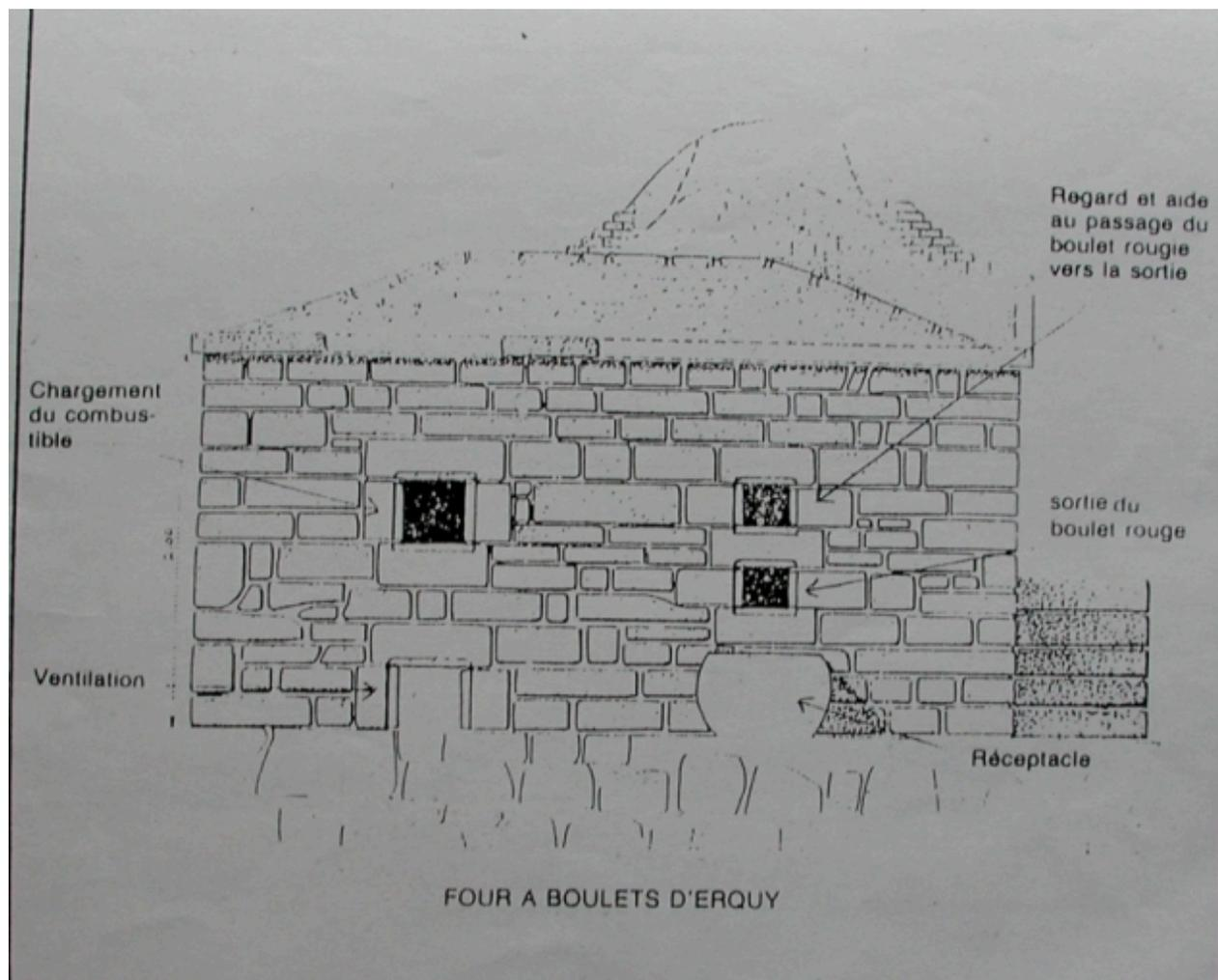
Fonctionnement du four à boulets d'après l'élévation de Lestienne Brevet
