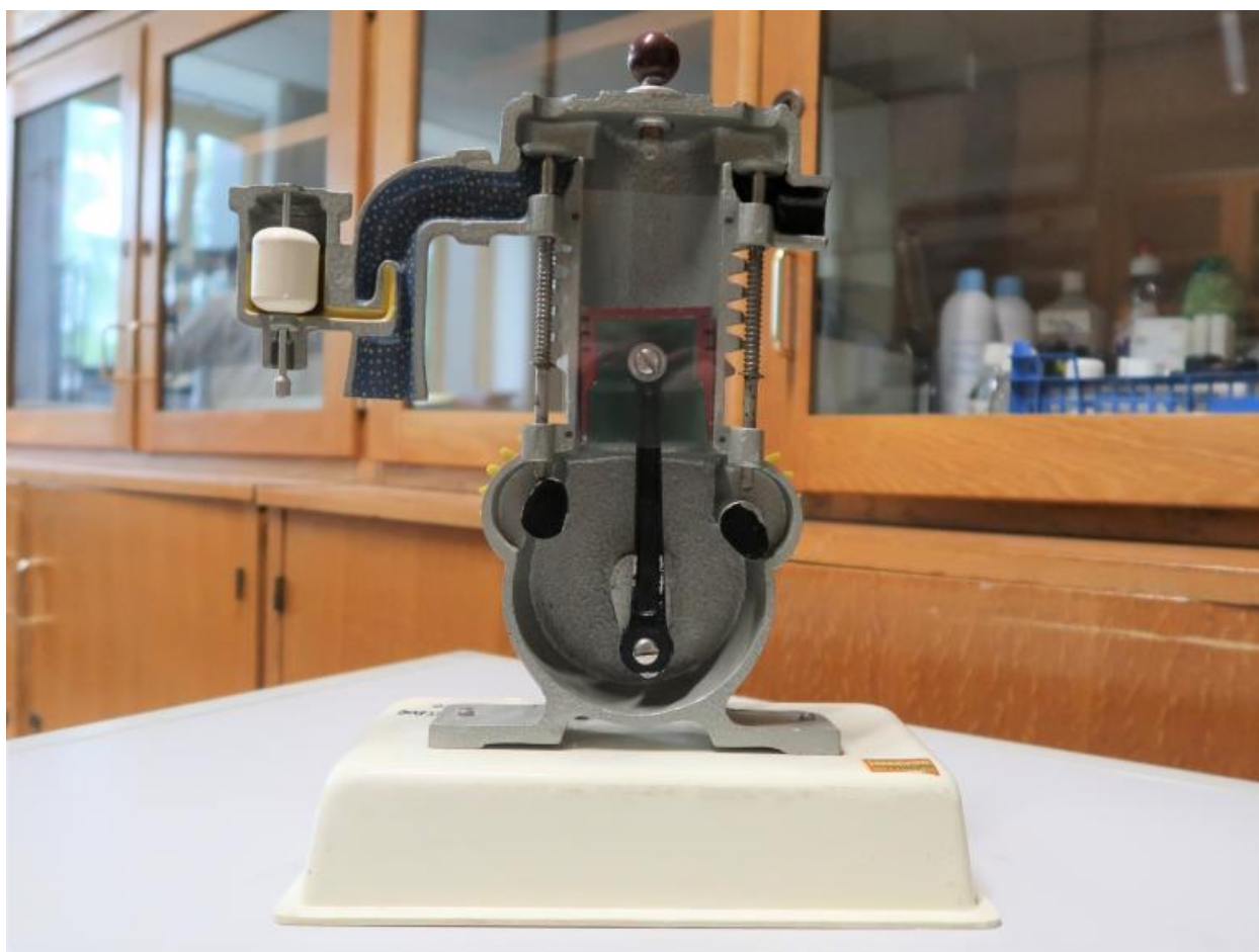
Modèle de moteur à explosion - Chaleur (Pierron)
