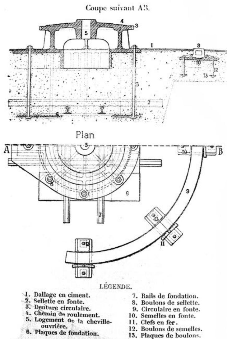
Fig. 96. — Plate-forme pour affût de 27<sup>e</sup>/<sub>m</sub>, M<sup>le</sup> 1886 P.A.
