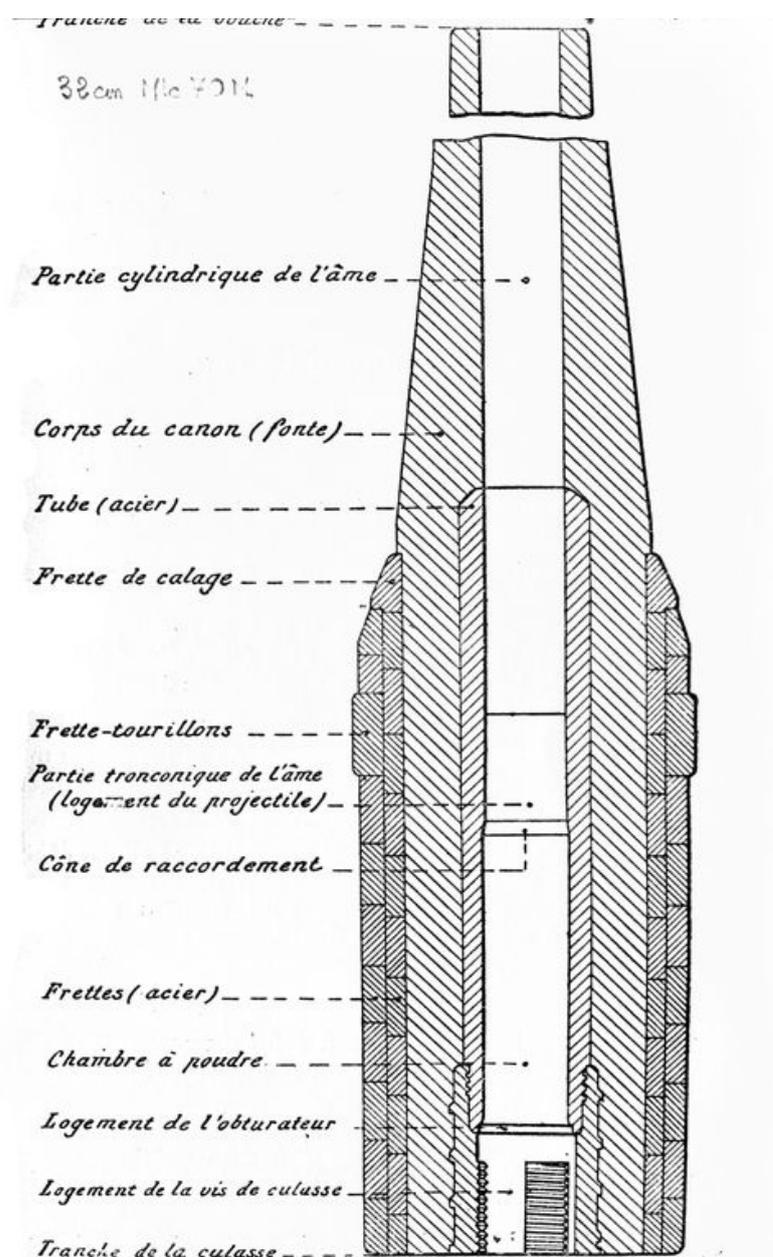
Coupe d'un canon de 32 cm modèle 1870 M (armement des batteries de Sept, du bastion n° 26, du fort de l'Armorique et de la pointe des Espagnols sur affût modèle 1876-T-83 PA)
