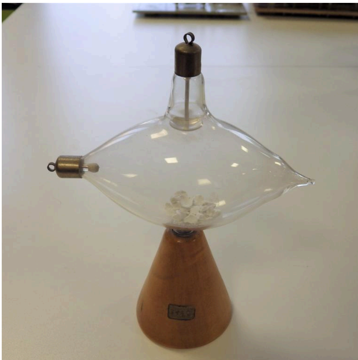
Tube à vide avec minéraux phosphorescents - Electricité dynamique (Non signé)
