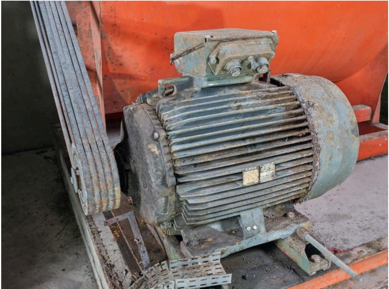
Vue de la salle des ventilateurs : moteur électrique de la Compagnie Electro-Mécanique entraînant via des courroies un ventilateur industriel de marque Fevi. Les fils d'alimentation ont été coupés
