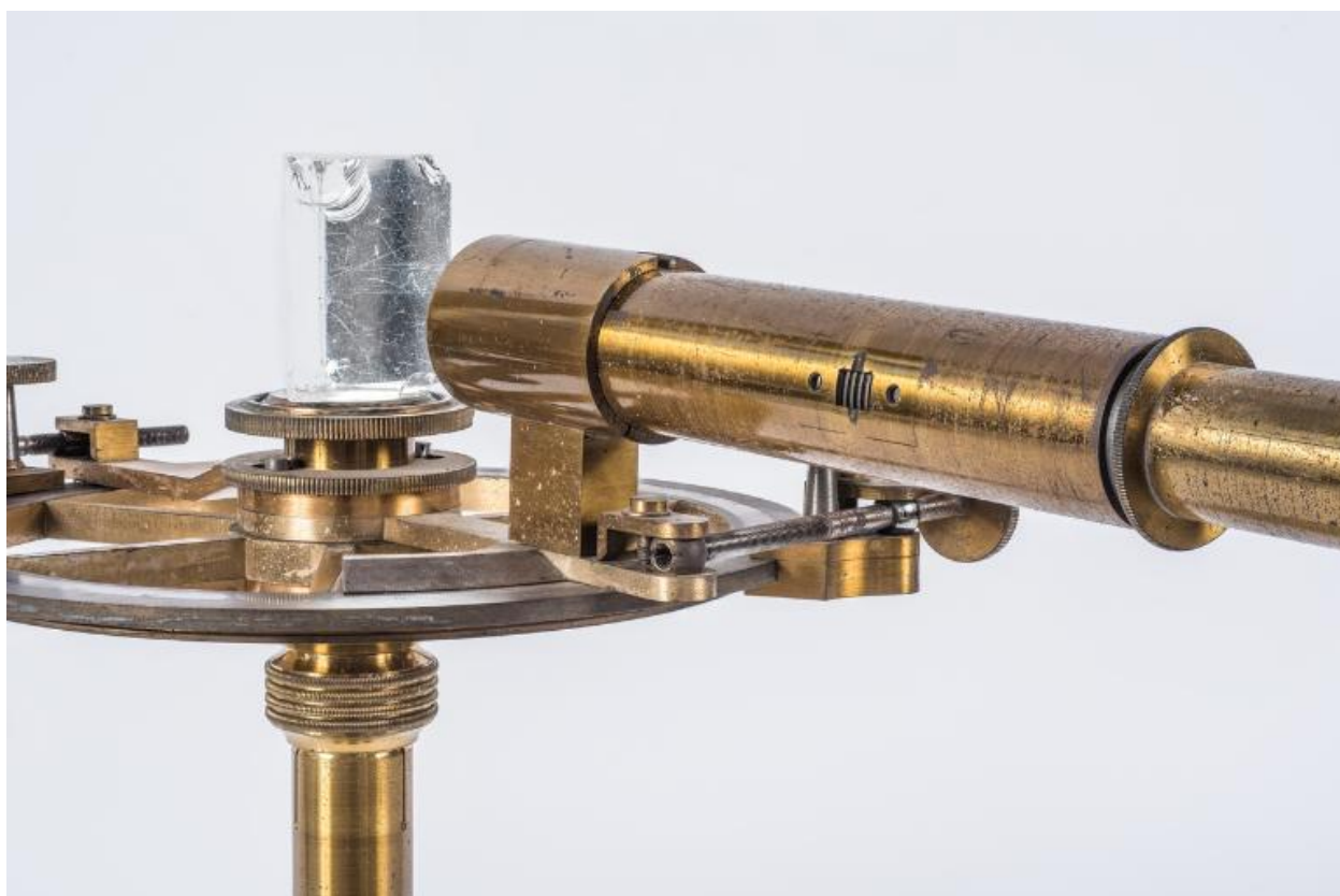
Détail de la lunette mobile du goniomètre de Babinet
