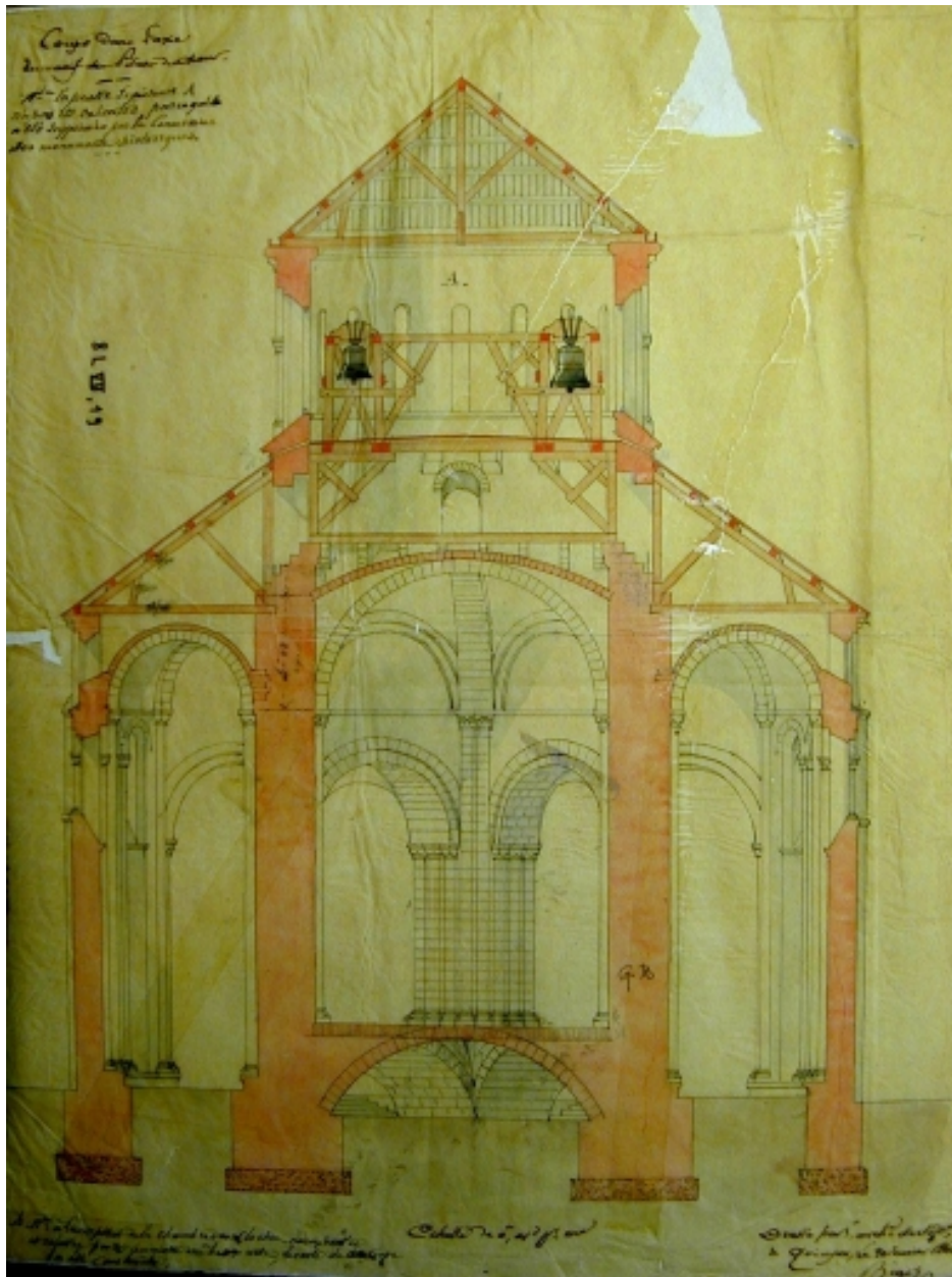
Coupe dans l'axe du massif des piliers du choeur et chambre des cloches. Partie A : non réalisée. Dessin Gustave Bigot, vers 1864-1866 (A.E. Quimper, Fonds Bigot)
