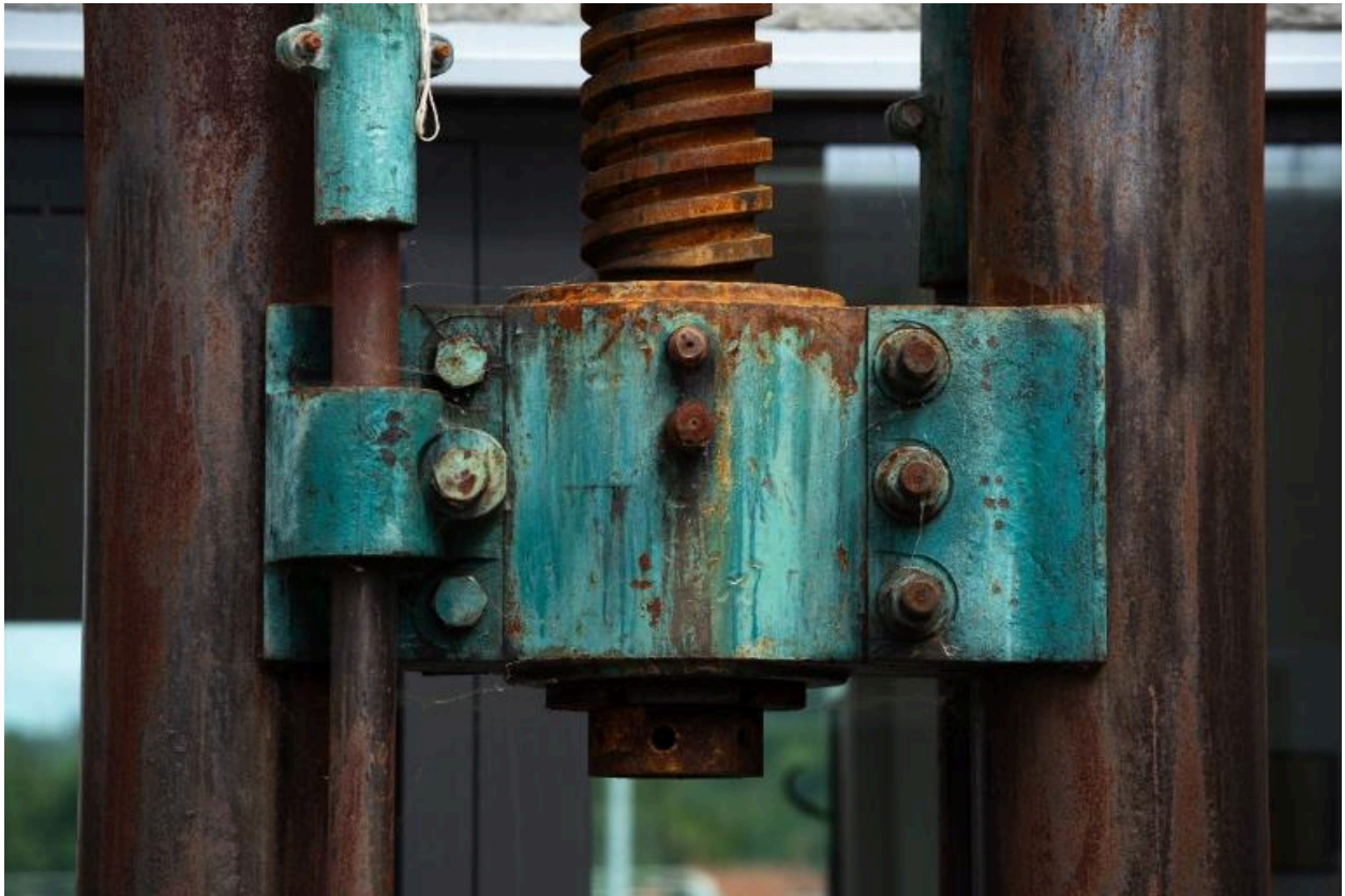
Vue de détail : porte-outil avec son logement de gaine de vis et la bouterolle (état en 2025)
