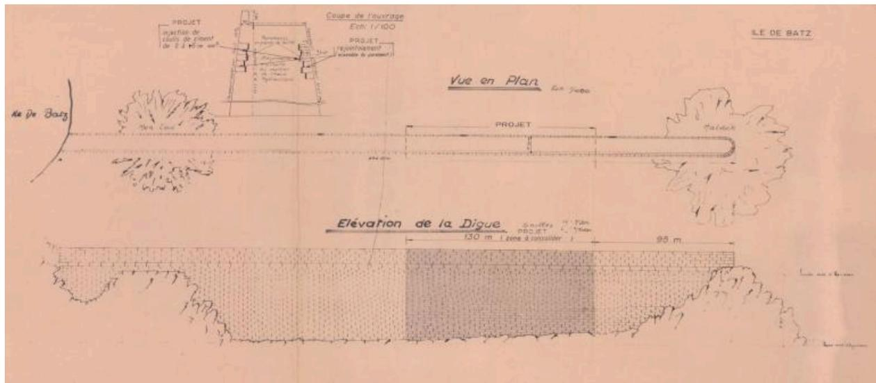
Plan : coupe et élévation de la digue (1992)
