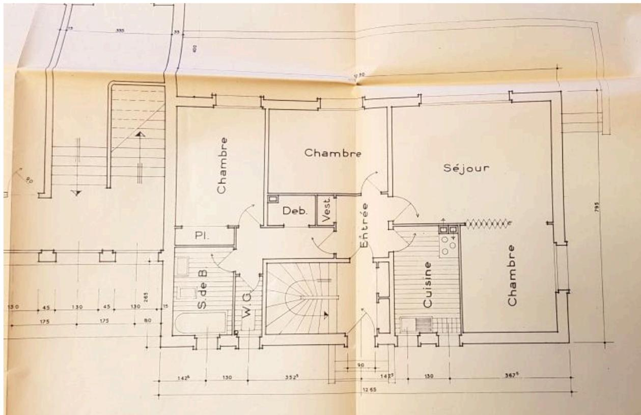
Plan d'un logement de fonction, construit dans le prolongement d'un externat (G. Tourry, architecte, 1954).
