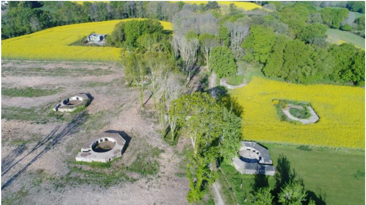
Vue générale oblique depuis l'est des six bunkers-cuves de type FI243a pour canon antiaérien de 10.5 cm et des deux bunkers-postes de direction de tir pour télémètre
