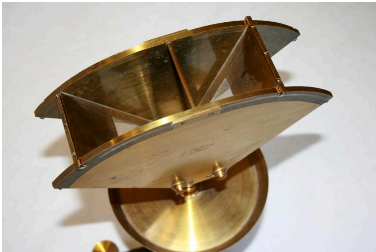
Intérieur du prisme à angle variable - Optique-Géodésie (J. Duboscq, 1880-1883)
