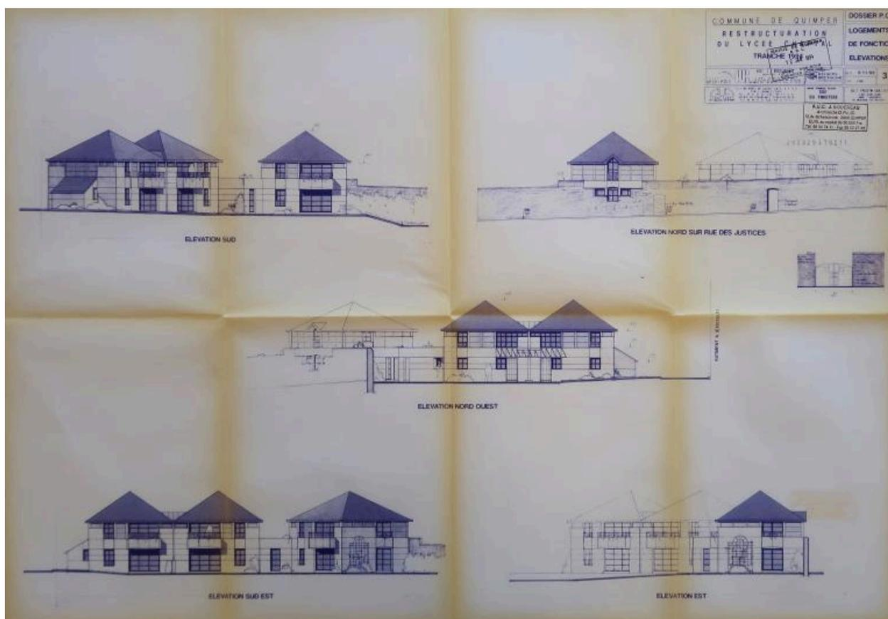
Logements de fonction, élévations. Restructuration du lycée Chaptal, tranche 1994. Jean Bodereau, architecte, plans de novembre 1993. Noter l'insertion de l'un des logements dans le mur d'enceinte.
