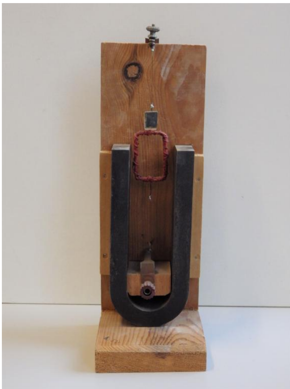
Galvanomètre à cadre mobile (sans bobine) - Electricité dynamique (Non signé)
