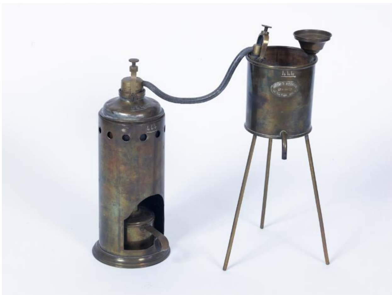
Alambic pour l'essai des vins - Chaleur (Dujardin Salleron)
