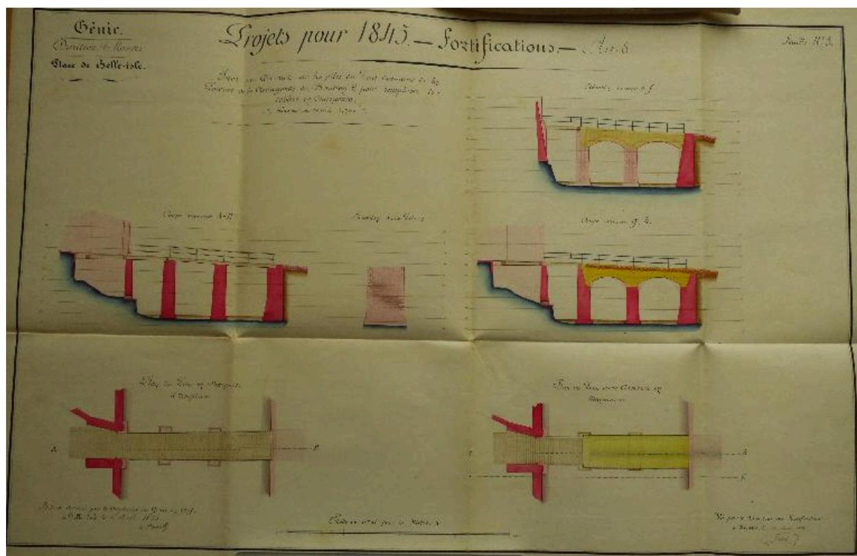
1 VH 291. Place de Belle-Ile, feuille n° 3 des projets pour 1845, faire des arceaux sur les piles du pont dormant de la poterne de la contregarde du bastion 2 pour remplacer les tabliers en charpente, 1er avril 1845.
