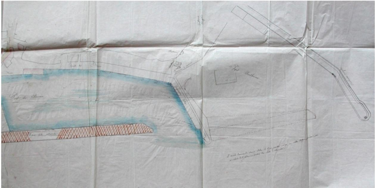
Plan : projet d'amélioration du port de Binic, coupure de la vieille jetée, suppression de la cale de construction et prolongement du môle sud, 1862 (AD 22)
